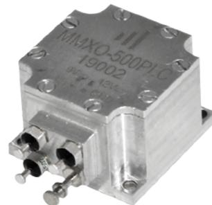
Генератор MMXO-500PLC представляет собой комбинацию генератора термостатированного MOXO-100, умножителя частоты на пять и стабилизированного маломощного термостатированного ПАВ-генератора. Тщательно проработанная схема позволяет обеспечить синтез сигнала опорной частоты с наименьшими фазовыми шумами как на отстройках до 10 кГц, благодаря высокому качеству умноженного по частоте MOXO-100, так и выше 10 кГц, благодаря маломощному термостатированному ПАВ-генератору.
